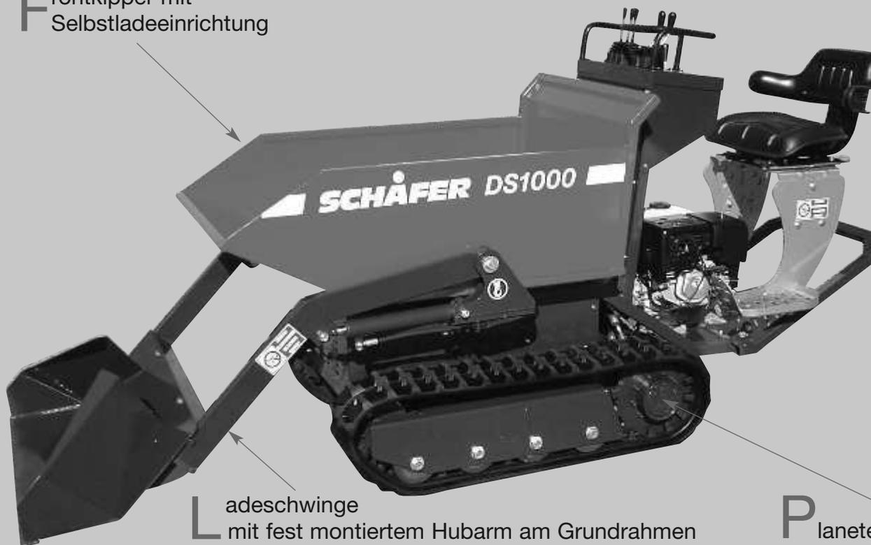
**L**adeschwinge mit fest montiertem Hubarm am Grundrahmen
