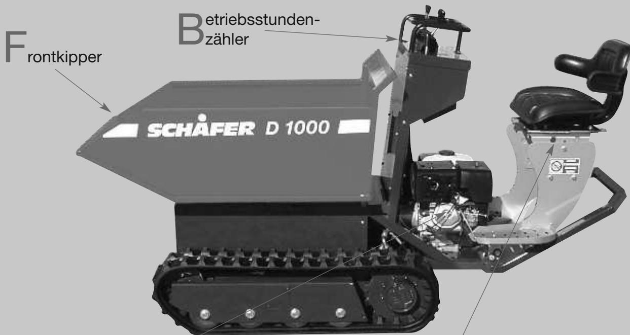
**E**inzylinder Benzinmotor mit Elektrostarter
