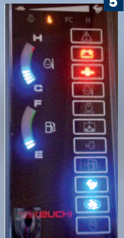
Übersichtliches Display mit optischer und akustischer Überwachungseinheit.
