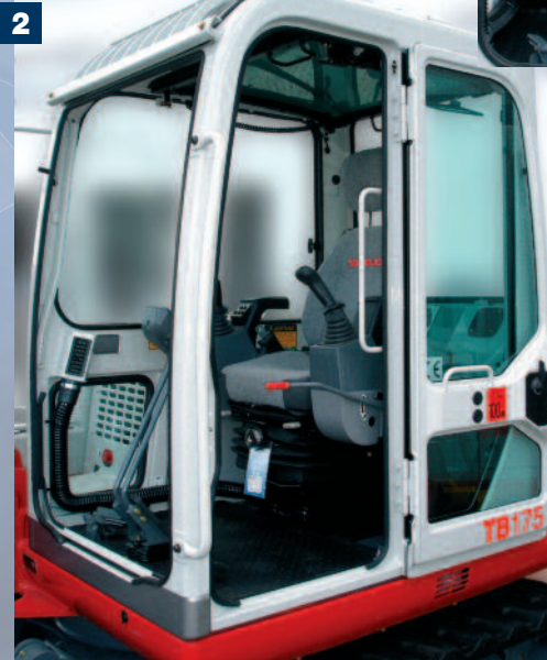
Obere und untere Frontscheibe ist einziehbar.
