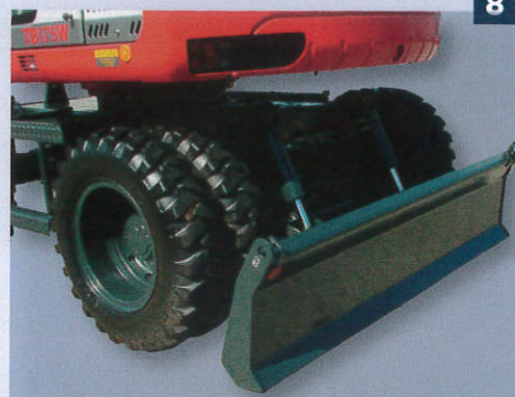
Planierschild mit extra stark profilierter Kontur sowie glatter und breiter Auflage unterhalb der Schneide
