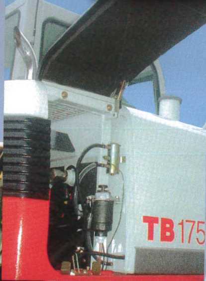
Summenleistungs- geregelte Hydraulikanlage für kraftvolle und feinfühligere Arbeits- bewegungen
