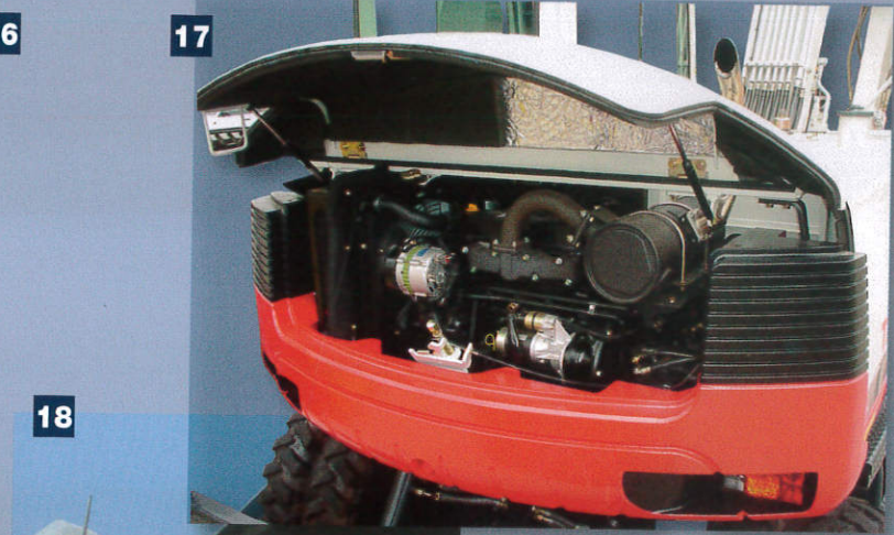
Seitlich nach oben gezogene Kontergewichte zum Schutz der gesamten Heckpartie.
