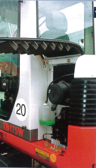
Abdeckklappen an allen Seiten für direkten Zugang zu Aggregaten
