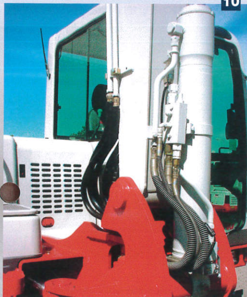
Hubzylinder mit Endlagedämpfung
