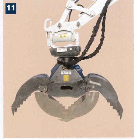
11 3. Funktion Der Mehrzweckgreifer wird mit dem Schieberegler auf dem rechten Joystick geöffnet und geschlossen.
